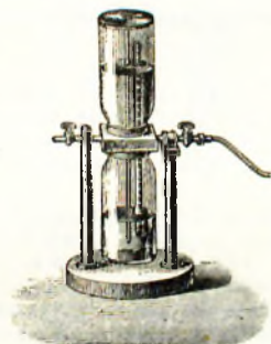
Ryc. 203. Aspirator działający naprzemian. (W/g Fehling'a).
